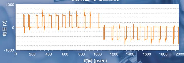
驱动电机的变频器电压，是一种高速重复开关动作的波形。每次进行开关动作时，都会产生超过开关电压两倍的浪涌电压，给电机内部的绕组间施加瞬间高压。这种重复的变频浪涌电压会加速绕组的绝缘老化。
