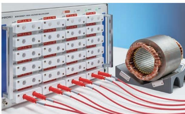
各类电机定子测试仪器均可通过SW2001进行集成
