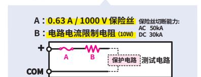
(※)关于DC1000V以上电压测量、只有满足以下两个条件的测量对象才能使用: 1. 与电源系统分开 2. 与大地绝缘
