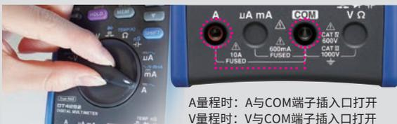
DT4281/4282结合测量功能、关闭不使用的探针插入端口保护功能以防止误插入。
