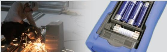
DT4255即便遇到铁粉等粉尘入侵时也不会引起内部短路，内置有保护电压输入端口的保险丝。此外，自己也能更换保险丝。
