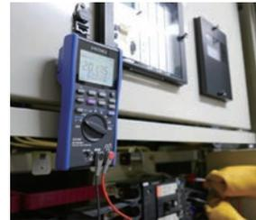
测试仪主机或测试探针, 记录用纸等手动操作不太流畅。这些现场问题可以通过磁性吊带, 自动保持、内部存储一并解决。提高作业效率, 缩短作业时间。
