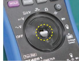
测试仪内部进入粉尘也是导致故障一大原因。特别是旋钮开关的缝隙极易容易吸入, DT4200系列的旋钮开关被称为O环, 增加了防尘零件提高防尘性能。
