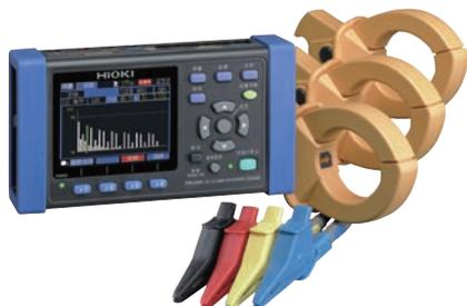
可将每个间隔时间的最大/平均最小值以二进制的格式保存在SD存储卡上。
