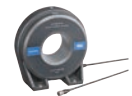
AC/DC 电流传感器 CT6877A 额定电流 AC/DC 2000 A, 频率特性 DC ~ 1 MHz, φ 80 mm, 线长 3 m
