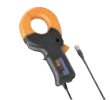
AC/DC 电流探头 CT6845A 额定电流 AC/DC 500 A, 频率特性 DC ~ 200 kHz, φ 50 mm 线长 3 m
