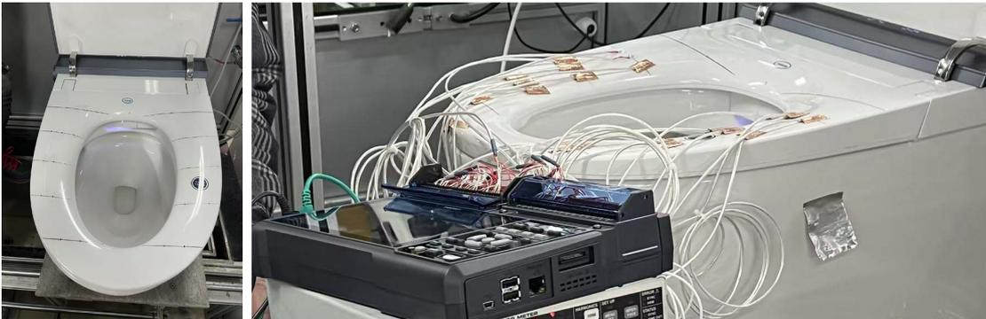
在数据采集仪LR8450-HR【通道】界面将输入设置为【热电阻】并选择量程与热电阻种类后,开始采集。
