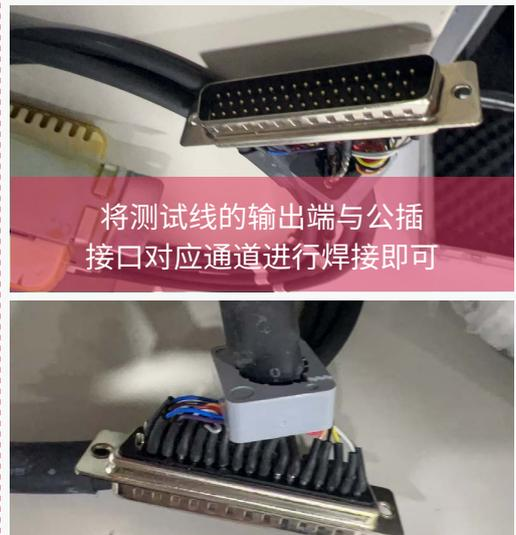
将测试线的输出端与公插接口对应通道进行焊接即可
